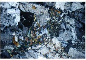
調査依頼を受けた「麦飯石」から、学芸員が作成した岩 石薄片の写真です。上下の写真は、別々の「麦飯石」です。 薄片写真から、これら両方とも、花崗岩質深成岩(カリ 石は、風化や変質もないものですが、下の岩石は、変質 が進んでいて、色鮮やかで細かい別の鉱物ができていま す。写真の横幅は両方とも約6cmです。
