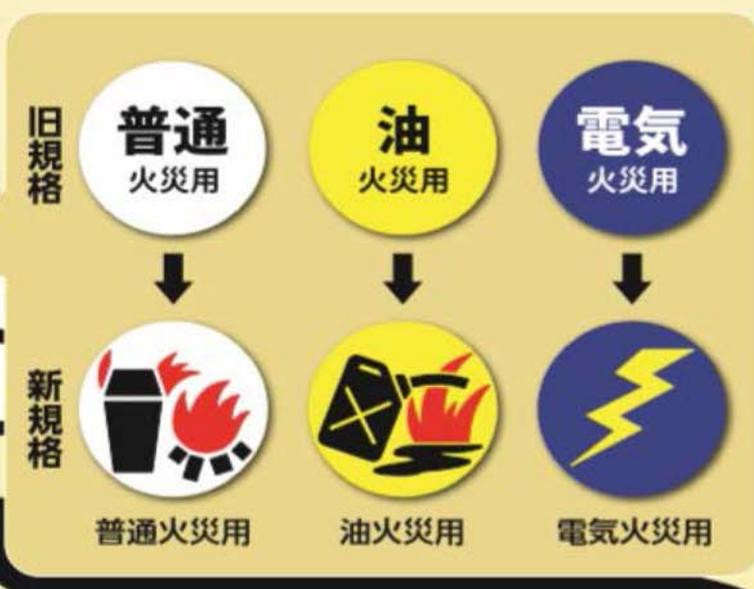
消防法令に基づいて消火器の設置が義務付けられている建物等で、2011年1月1日の規格省令改正により既に型式が失効している消火器を継続的に設置できるのは2021年12月31日までです。2022年1月1日以降は、型式が失効した消火器の設置は認められませんので、計画的な交換・リサイクルをお願いいたします。
